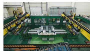
Figura 1 | Equipo de apilamiento automático de los núcleos de hierro
