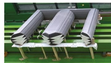
Figura 2 | Apilamiento del núcleo de hierro terminado
