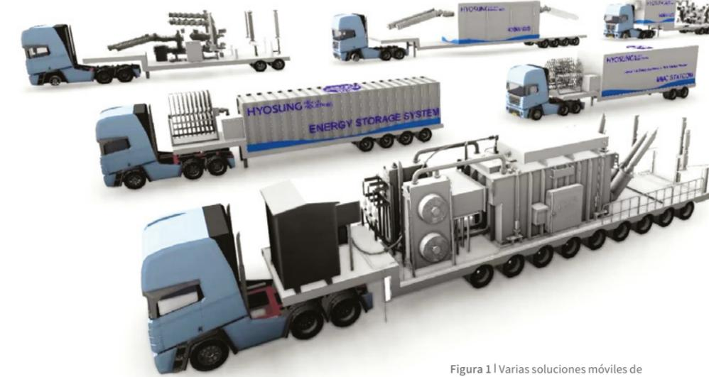
Figura 1 | Varias soluciones móviles de Hyosung Heavy Industries
