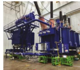
Figura 1 | Transformador con aislante a base de aceite de éster sintético - 400kV 240MVA
