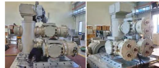
Figura 5 | Prueba de vibración
