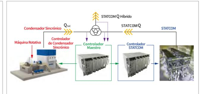
Figura 3 | Configuración del Sistema STATCOM Híbrido
