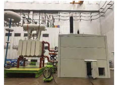
그림4 | 방음실 구조 실증 테스트
