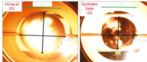
그림2 | 방폭 실증 시험, 광유와 생분해성 에스테르유의 각 에너지에 따른 버블 사이즈 확인
