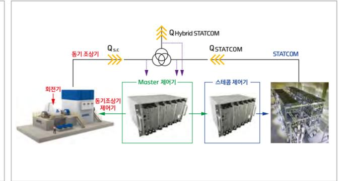
그림3 | 하이브리드 스테콤 시스템 구성도
