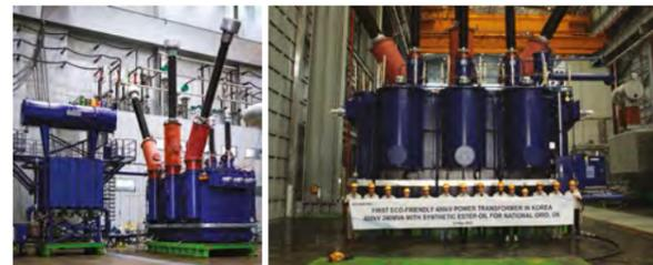
그림1 | 국내 최초 400kV 생분해성 에스테르유 변압기 개발
