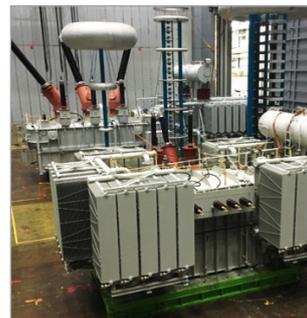
[그림 2] 132kV 133MVA 친환경절연유변압기
